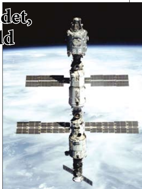
A Nemzetközi Űrállomás kezdetben ilyen karcsú jármű volt. Fentről lefelé a modulok, a Unity, a Zárja, a Zvezda, illetve egy dokkolt Progressz teherhajó látható. A fotót az Atlantis űrsiklóról készítették 2000 szeptemberében
