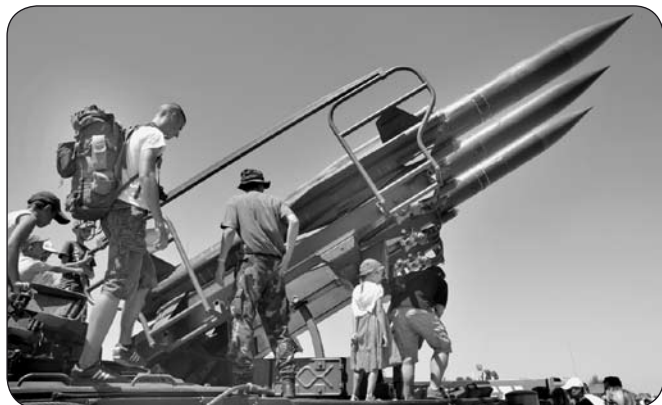
Az 2K12-es, KUB rakétarendszer. A szovjet légelhárítás alappillére, a NATO a Gainful (Hasznos) kódnevet ruházta rá. 1959-ben tervezték, később legalább félezer lánctalpas kilövőjárművet gyártottak hozzá (házánk légvédelmének egyik fontos pillére, nehezen megsemmisíthető, mivel kilövés után pillanatok alatt helyet változtat)
