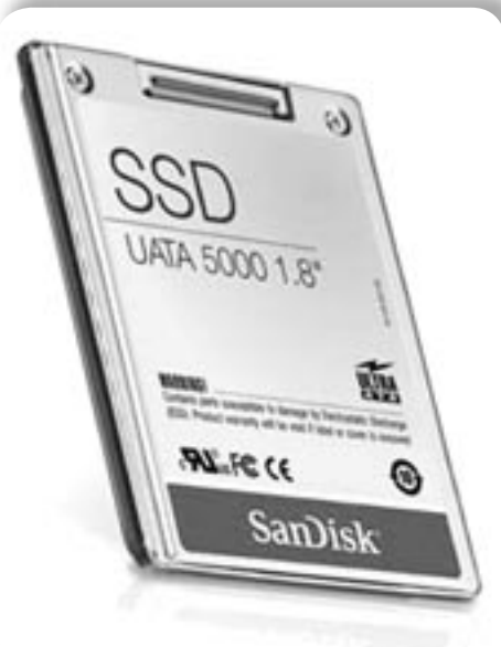
A 32 GB-os SanDisk flashlemeze (Solid State Disc)
